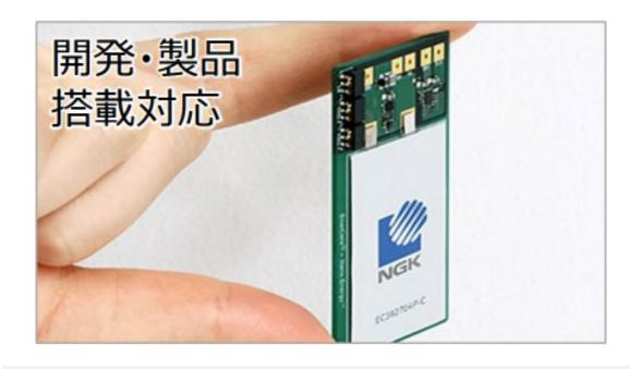
EnerCeraとローム「Nano Energy™」 搭載の降圧DC/DC等のICを実装した評価 ボード。製品への搭載も可能なデザイン
