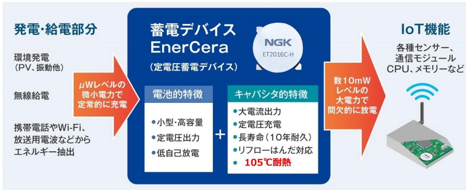
液系Liイオン電池とスーパーキャパシタ両方の特性を併せ持つEnerCeraが「メンテナンスフリーIoTデバイス」を実現します
