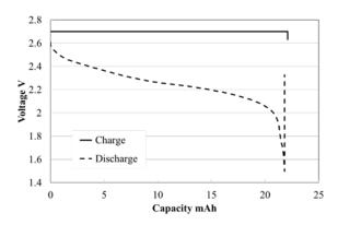
Charge : CV / 2.7V /cutoff 0.2C / 25°C Discharge : CC / 2.0C / cutoff 1.5V / 25°C
