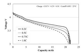
Discharge : CC / 0.2C, 0.5C, 0.75C, 1.0C / cutoff 3.0V /  $25^\circ\!C$
